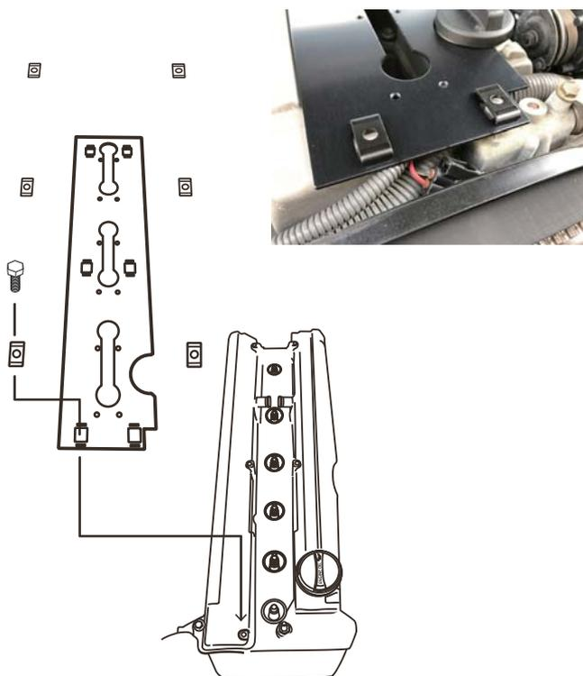
4. ①パワーコイルを付属の⑤六角穴付きボルト (M6x15) を使用して取り付けてください。6番はバルクヘッドに干渉する場合、角度をつけられるように数か所タップが切られています。
