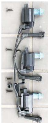
3. ②コイルブラケットを付属の⑦コイルブラケットホルドプレートと⑥六角ボルト (M6x15) を使用して取り付けてください。
