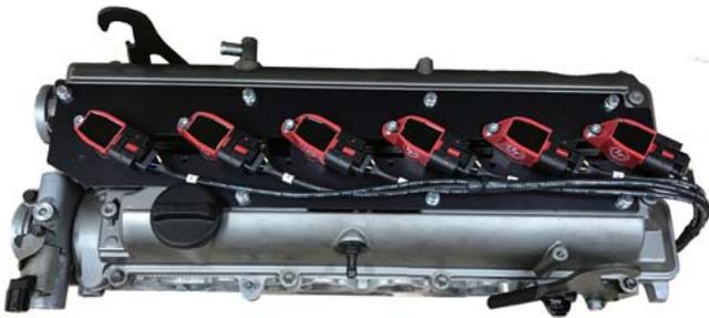
7. 最終ページの配線図を参考にして、ECUからの5V信号、12V電源、アース(Ground)の配線をしてください。
