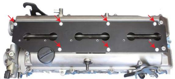
5. ①パワーコイルを付属の⑤六角穴付きボルト (M6x15) を使用して取り付けてください。写真はコイルをインテーク側に向けていますが、エキゾースト側に向けることもできます。6番はバルクヘッドに干渉する場合用に数か所の取付穴があります。
