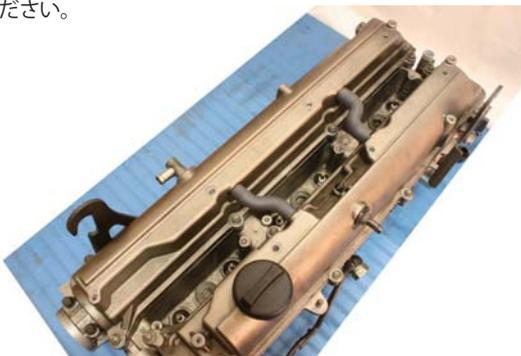
3. ②コイルブラケットを付属の⑥六角ボルト (M6x15) を使用して取り付けてください。
